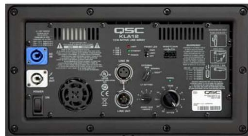
在一个固定安装应用中，多只 KLA 扬声器的增益可通过“菊花链”的连接形式来控制，可使用一个通过凤凰接口接入，带有可变阻抗的遥控面板来控制整套线阵的增益。
